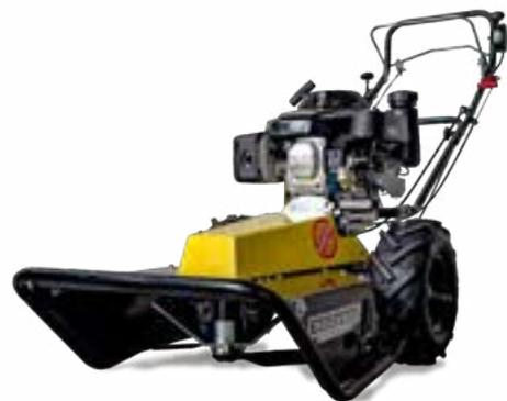
Desbrozadora oscilante para pendientes equipada con el original sistema de motor oscilante patentado SWING SYSTEM de 7 posiciones. Cuenta con transmisión mecánica en baño de aceite y variador de velocidad para ajustar el avance de la máquina en todas las condiciones de trabajo.
