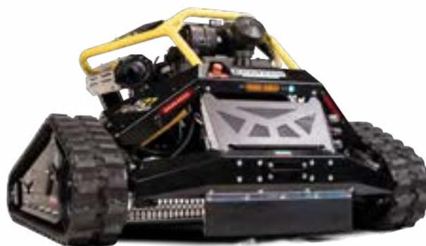
Máquina de control remoto sobre orugas diseñada para segar en condiciones extremas. Cuenta con placa forestal para pendientes extremas y plato de corte central de 80 cm para una máxima compacidad y agilidad.
