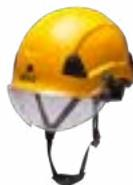
Diseñado especialmente para trabajos en altura. Ligero y ergonómico, su visor protector proporciona una visión panorámica excelente, cómodo arnés textil de 6 puntos. Ajustable por rueda, ideal para trepa EN 397 -30°C/+50°C EN 50365 Class:0. ANSI/ISEA Z89.1 TYPE I Class E
